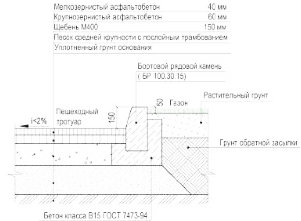
3.13.1 Схема устройства сопряжения асфальтобетонного покрытия и газона
